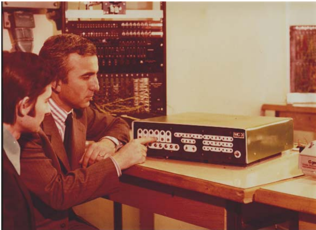
Fig. 1. Modelul de laborator MC3, bazat pe microprocesorul Intel 8008.
