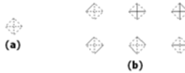
Fig. 24. Simbolul unui comutator NSEV (a) și unele configurații de comutare (b).
